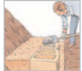
Fig. 4 - Relleno de núcleos
